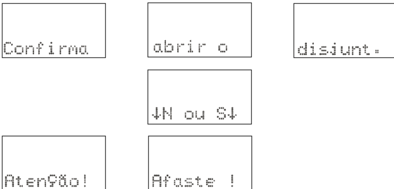
Figura 3.12: Comando local para abrir o disjuntor.
